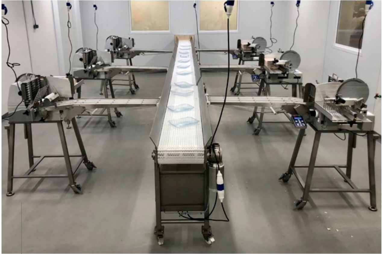
Configuración de varias cortadoras sincronizadas a línea de producción.
